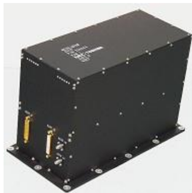
写真1 無調整化 TTC トランスポンダ (ATTC) の外観
