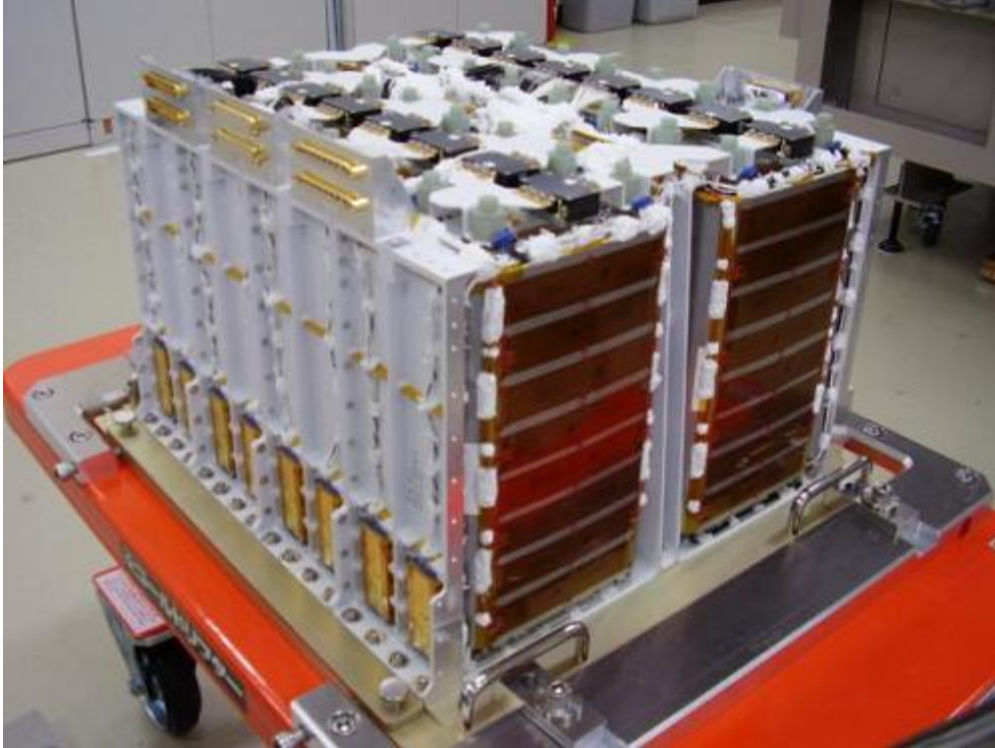
準天頂衛星初号機「みちびき」に搭載された リチウムイオンバッテリフライントモデル（16セル）
