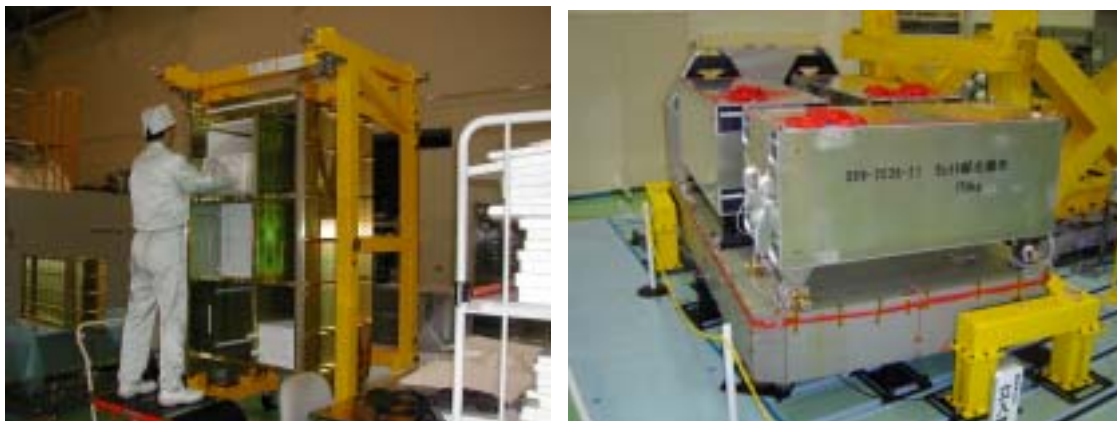
図-21 サブキャリア試験モデル(左:HTV 補給ラック 右:曝露パレット)
