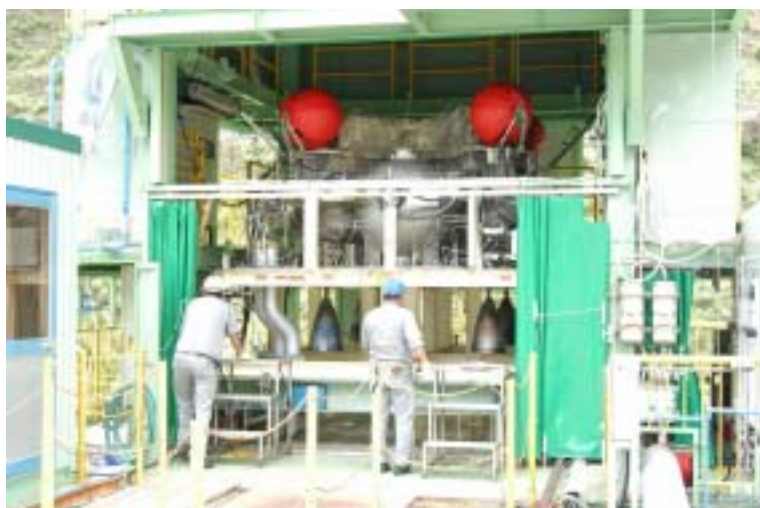
図-18 推進系システム燃焼試験
