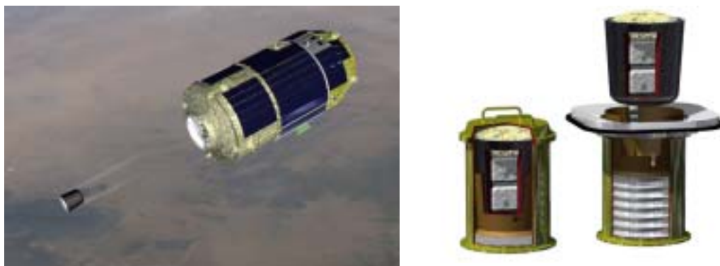
図-23 小型カプセル搭載による実験試料回収
