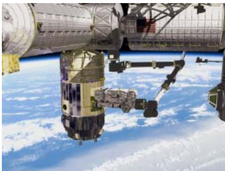
図-8 ロボットアームによって引き出される曝露パレット
