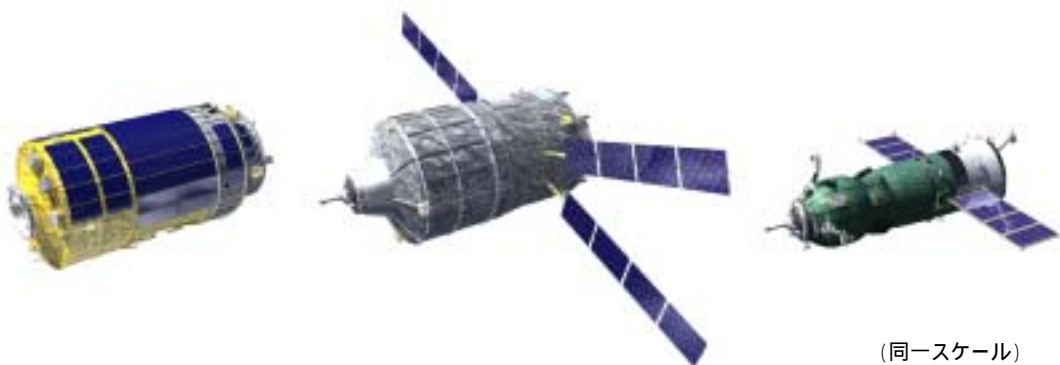
図-2 宇宙ステーション補給機比較(左からHTV、ATV、プログレスM1)
