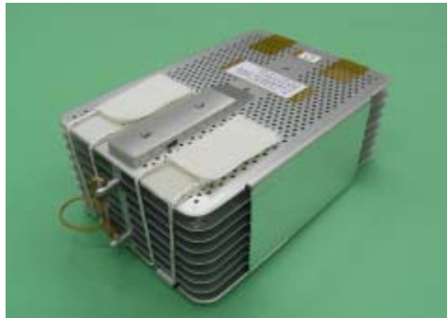
図-11 MEU収納用サンプルホルダ例(プラスチックバッグ型試料容器用)
