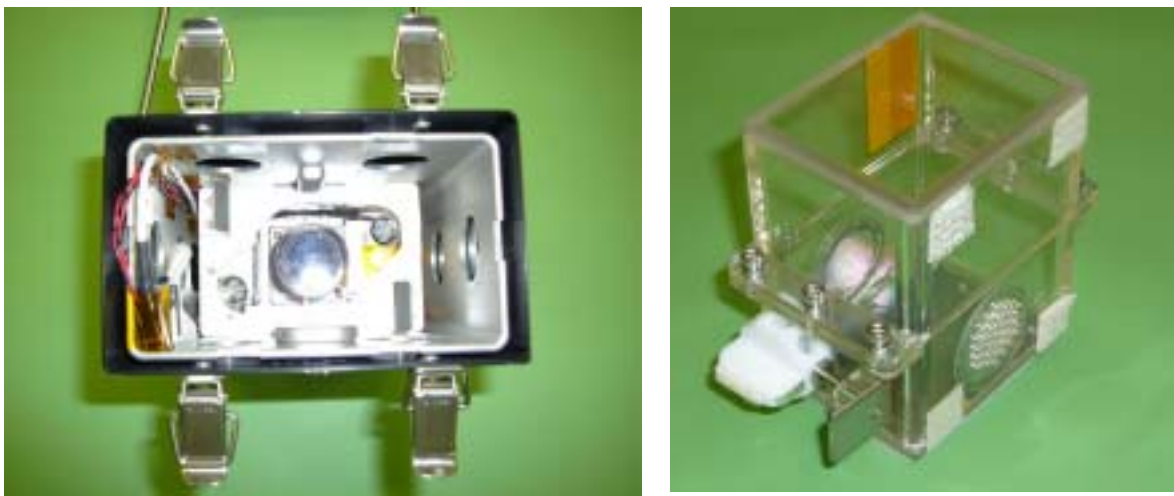
図-12 V-MEU内部CCDカメラ[左]及び動物試料容器[右]
