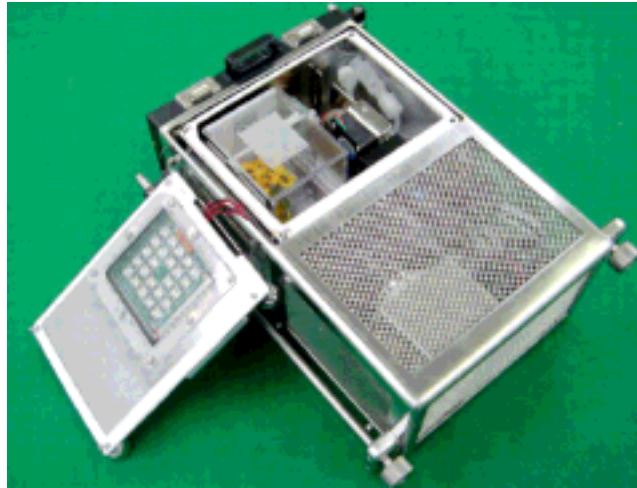
図-7 PEU本体(試料容器へアクセスする上面蓋を開けた状態)
