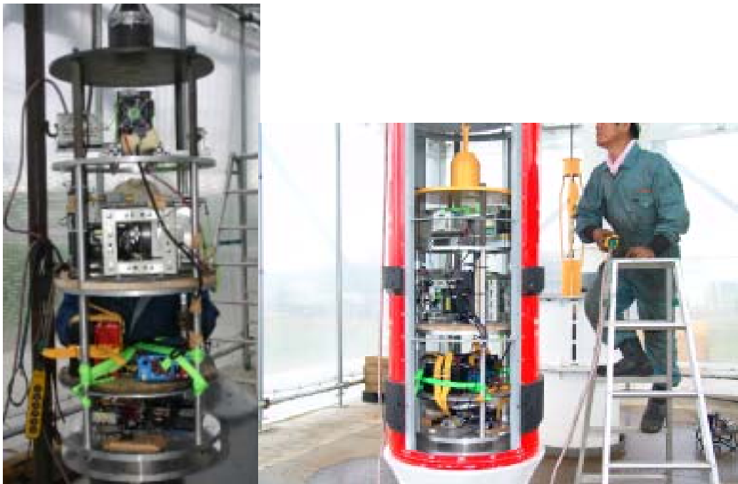
図7 実験装置を内カプセルに組み込んだ様子(左)および、これをコスモトール落下カプセルに組み込んだ様子(右)
