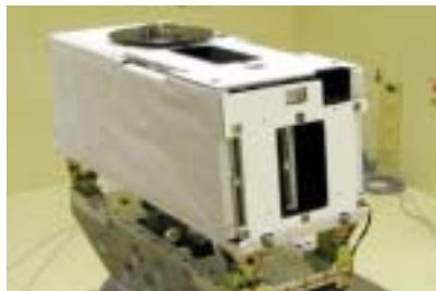
図7 全天X線監視装置
