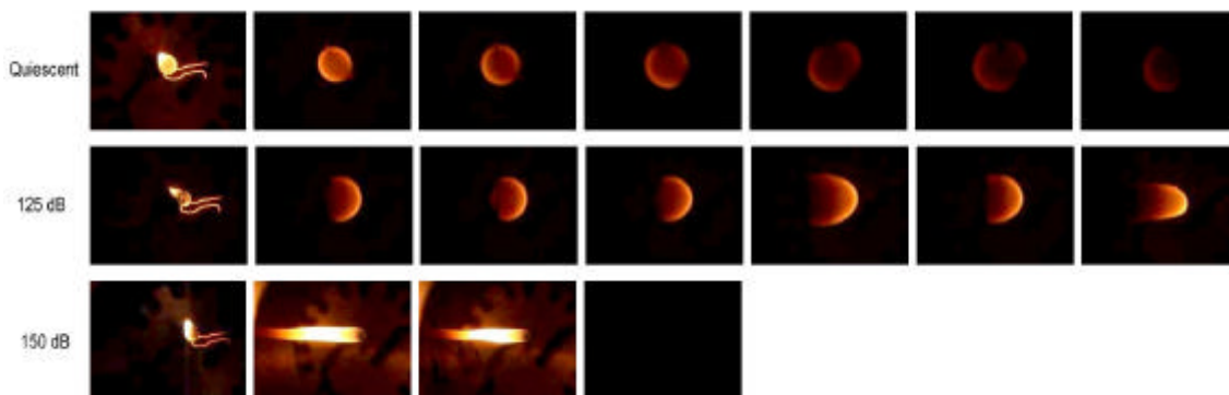
図4 定在音場中の火炎の時間変化（左が節の方向）
