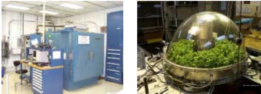
図8 米国KSCにおける低圧植物育成装置 (右が低圧チャンパー本体, 左がこれを収納する人工気象器)
