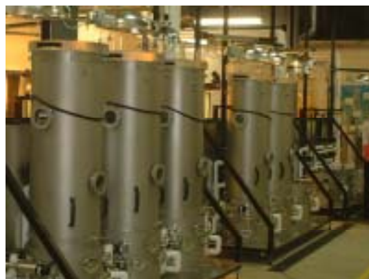
図10 カナダGuelph大学の低圧植物育成装置 (小型チャンパー, 5台)
