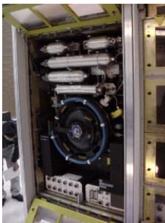
図15 米国燃焼実験モジュール (中央部にみえるリング状のハンドルを手前に引くと燃焼室が引き出される。上側に燃焼用ポンプ、下方にデータ収録用のインターフェースが見える。)
