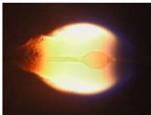
図10 微小重力場において電線被覆を燃え広がる火炎（周囲流速 5.2cm/s, 酸素濃度 21%, 被覆材ポリエチレン）
