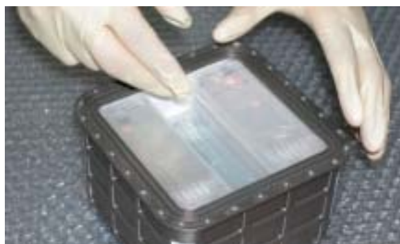
図7 Granada Crystallization Facility (GCF)概観 GCFにはGCB23個と自記式温度計が搭載される。
